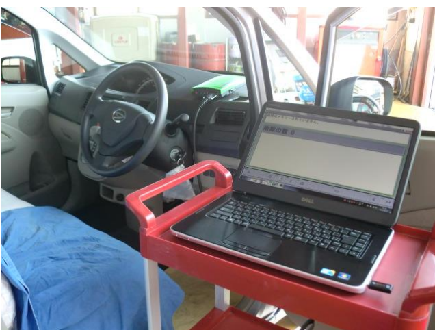
車のコンピューターと通信している様子です
